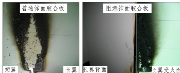
图3 普通与阻燃饰面胶合板燃烧后的样品外观
